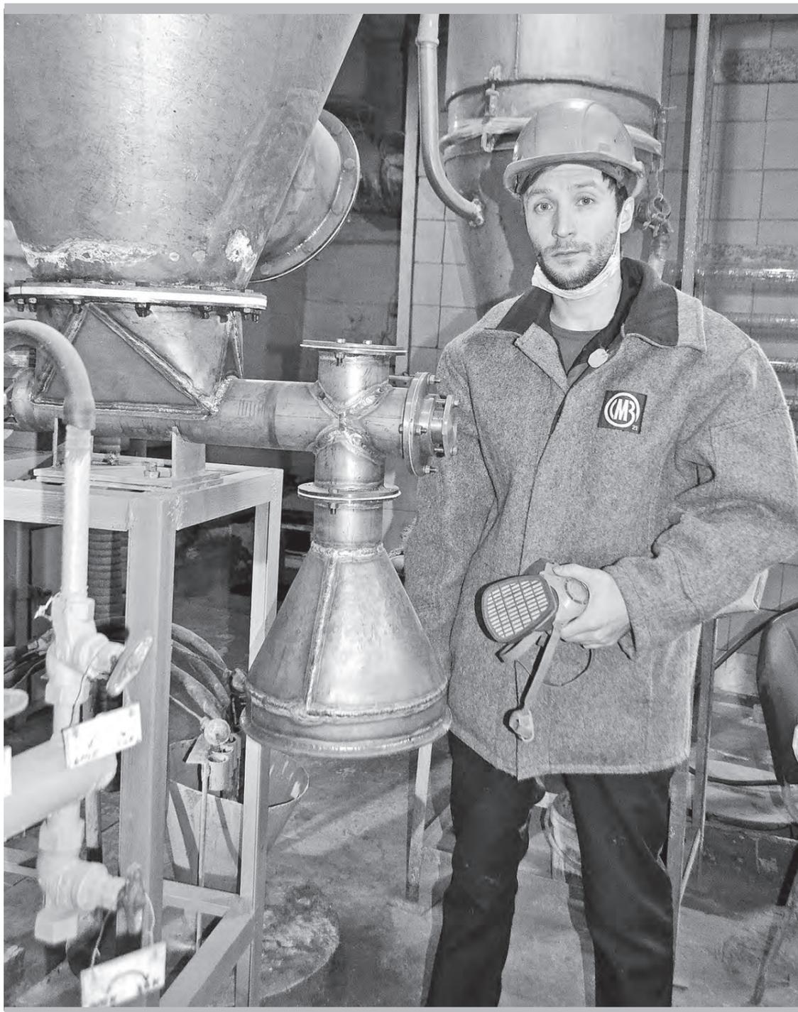
**Новый объёмный конденсатор с узлом выгрузки, который демонстрирует С.Н. Ивашов, аппаратчик в производстве титана и редких соединений, – одно из новшеств завершившегося 2021-го года по цеху № 3. По словам специалистов, его появление позволило снизить гидролиз при отгрузке в полиэтиленовые мешки продукта, получаемого на ректификации цеха. Более подробно о делах третьего цеха – на третьей полосе.**
