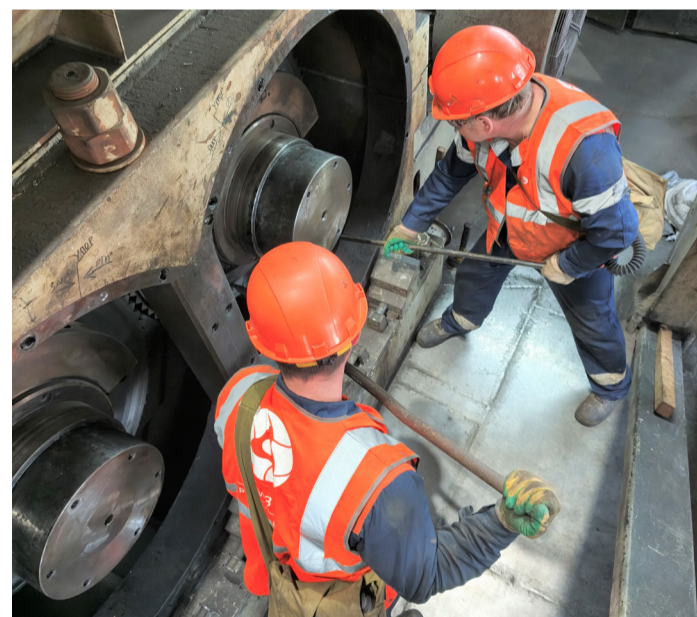
Специалисты механослужбы ведут замену дисковых ножей
