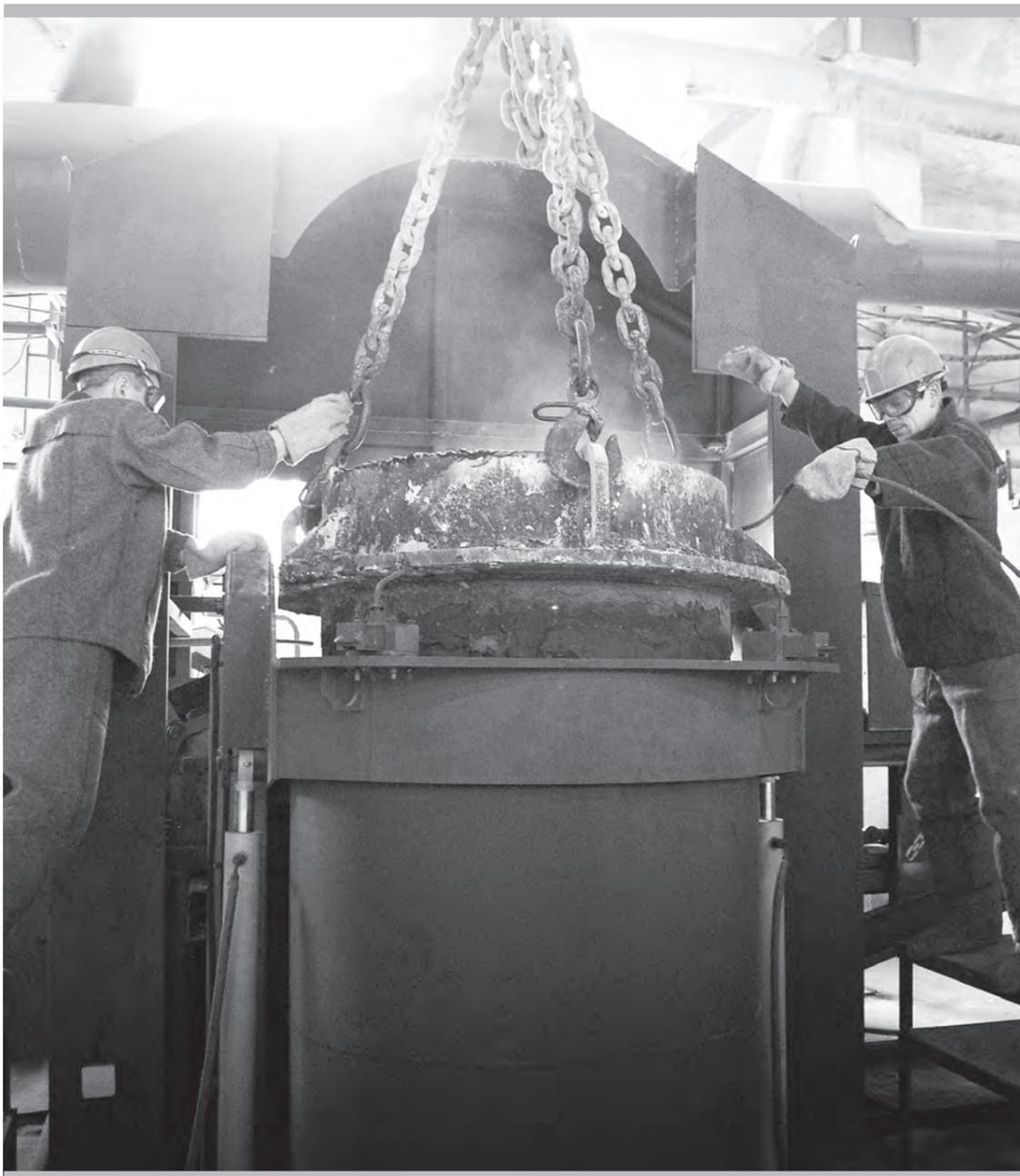
Пуско-наладочные испытания конвейера № 3 в цехе электролиза магния вышли на стадию отработки технологических режимов. Две-три секунды – и С.В. Брызгалов с К.Н. Седышевым, литейщики из смены О.М. Новикова, установив подготовленный к литью тигель с металлом, сядут за его «штурвал». Обкатку на новом конвейере к сегодняшнему дню успели пройти все смены литейного отделения. Пока – под руководством А.О. Павлюкова, старшего мастера отделения № 3. Все подробности – на второй полосе.
